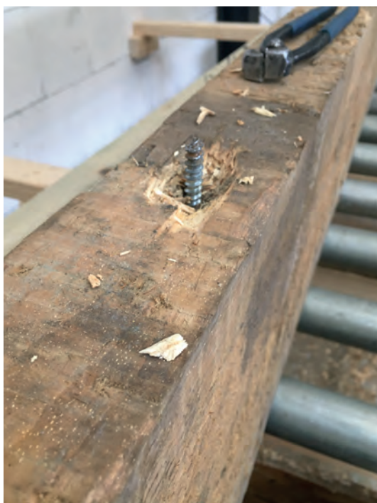
CirQ Wood laat metaal verwijderen uit hout dat wordt hergebruikt. 'Het hergebruiken van hout vergt veel arbeid en het rendement is soms laag.'
